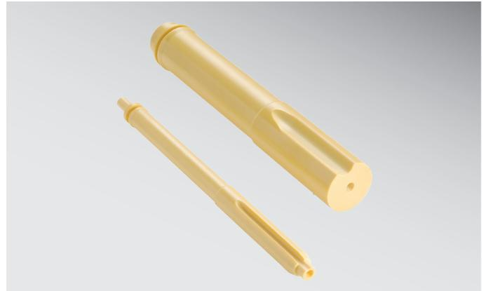
Kolben werden mit möglichst engem Spiel in Zylinder eingepasst. Die verbleibende Durchmesserdifferenz zwischen Kolben und Zylinder kann durch äußerst präzise Bearbeitung auf wenige  $\mu\text{m}$  reduziert werden. Mit dieser Technik kann auf Dichtungselemente wie O-Ringe etc. verzichtet werden. Dies hat erhebliche Vorteile hinsichtlich Standzeit und Sterilisierbarkeit gegenüber den metallischen Lösungen mit Dichtungselementen.
