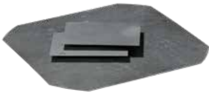
Prüfplatte aus Siliziumnitrid
