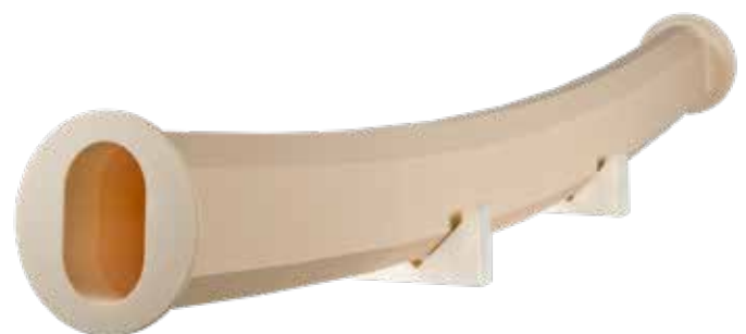
Abb. 2: Gebogene Vakuumkammer mit glasgelöteten Keramik-Keramik-Verbindungen, Biegewinkel: 15°, L 3.200 mm
