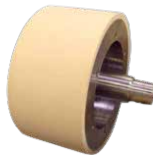
Keramischer Walzenkörper aus F99,7 (Außendurchmesser 250 mm) im Metall-Keramik-Verbund
